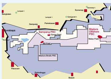
**Sumur Jeruk.** Pada 2006, operator lapangan ini telah menyelesaikan pengeboran dan pengujian Jeruk-3 sebagai sumur deviasi untuk mempenetrasi carbonate reservoir Kujung di *crystal-rich* wilayah bagian barat struktur Jeruk. Pemrosesan dan interpretasi seismik diselesaikan awal 2006 dan menghasilkan evaluasi sementara bahwa cadangan Jeruk berkisar antara 17-53 MMSTB.
